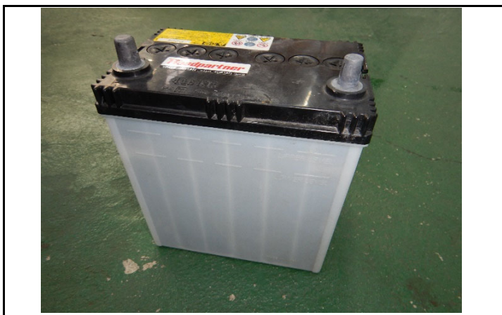
自動車バッテリー ※液漏れはNG
